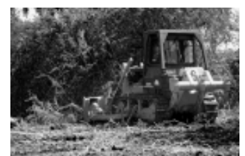
Der Cuba-Sí-Bulldozer knickt mit der Schaufel die Marabú-Stämme ab und zieht anschließend mit den Greifern die tief liegenden Wurzeln aus der Erde
